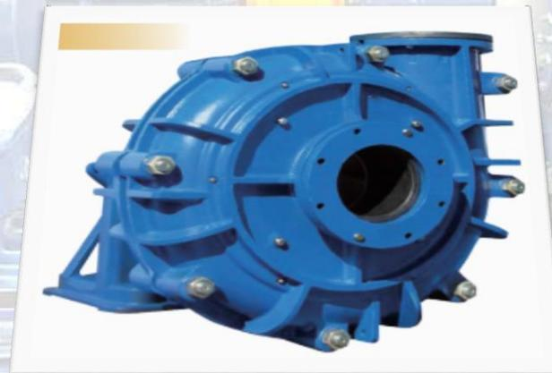
Les pompes de type AJG (H) sont à un étage, à simple aspiration, pompe à lisier centrifuge en porte-à-faux, horizontale. conçu pour manipuler l'abrasif supérieur le plus difficile les boues qui contiennent des solides trop gros pour être pompées pompes courantes, adaptées à la distribution de boues dans les mines, boues explosives dans la fonte des métaux, dragage dans drague et cours de rivières, et autres déposés.
